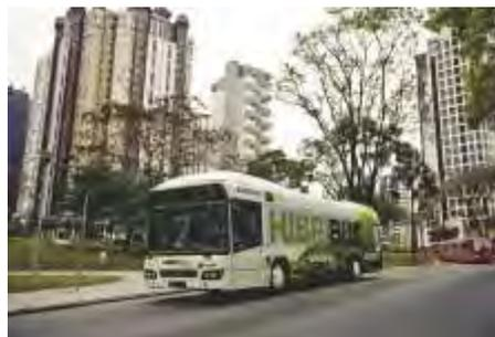
A partir deste ano, a Volvo Bus Latin América irá fabricar ônibus híbridos no país e a fábrica irá produzir o chassi 7700 Hybrid movido à eletricidade e a diesel. A nova tecnologia, além de economizar diesel em até 35%, reduz emissões de gases poluentes entre 80% e 90%. O ônibus terá sistema que integrará dois motores, um a diesel e o outro elétrico, sendo que o propulsor alimentado a diesel funciona a partir da velocidade 20km/h. O
